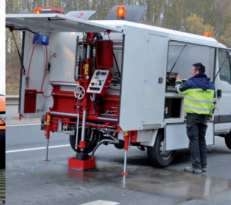
Schnelles, selbstfahrendes Kernbohrgerät
