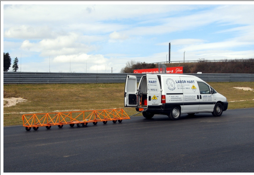
Bild 1: Die Baustoffprüfer vom Neuwieder Labor Hart identifizieren mit dem hoch sensiblen Planografen selbst geringste Fahrbahnnunebenheiten im Bereich von +/- 2 mm.
